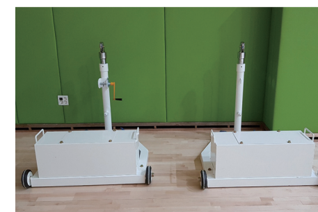
AB-204 좌식배구지주 / 베벨기어식 · H 남자 : 1150mm, 여자 : 1100mm · \phi 76.3mm 탄소강관 · 정전기 분체도장
