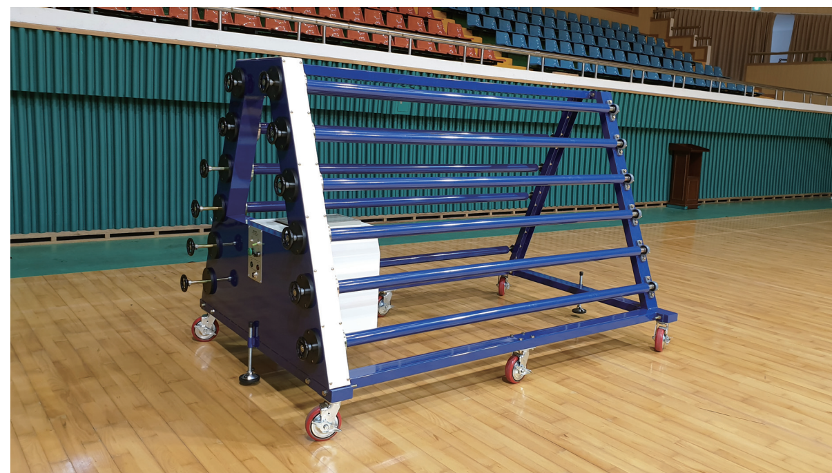
AG-503 전자동매트 권치기 겸 보관대 / 12롤용 · 폭크기 : 2400(W)×1650(L)×1600(H)mm · 전원 : AC220V, 1Hp · 흔들림 방지용 브레이크 부착 · 인버터장착 (속도 조절 기능) · 작동 : 전동구동방식 (정/역 회전) · 적용매트 : 2050, 1830, 1200mm · 정전기 분체도장 (SHOT 처리 후 도장)
